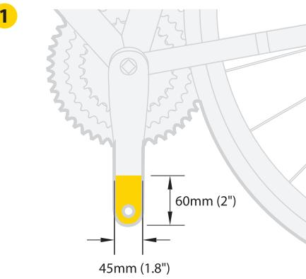
Der FlashStand FAT ist konstruiert für den Gebrauch an Fahrrädern mit einer Kurbelarmbreite von weniger als 45 mm (1.8") auf den letzten 60 mm (2") des Kurbelarms.
